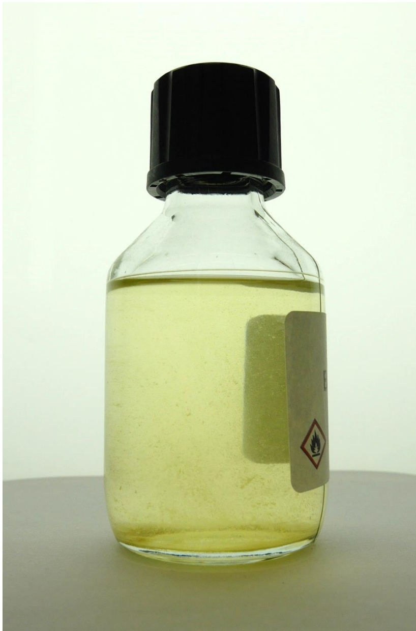
Benzin mit aufgewirbelten Alterungsprodukten (Flocken)
