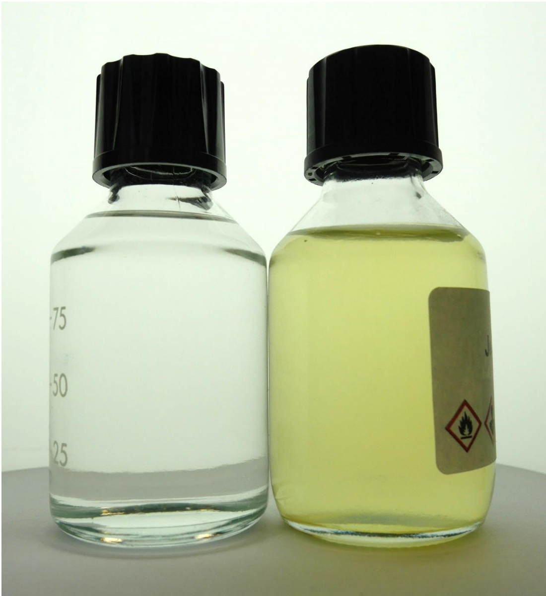
Flugpetrol/Jet A-1 frisch (links) und ca. 6 Jahre gealtert und trübe (rechts) (Die graue Tischkante ist durch die rechte Probe nicht mehr zu erkennen.)
