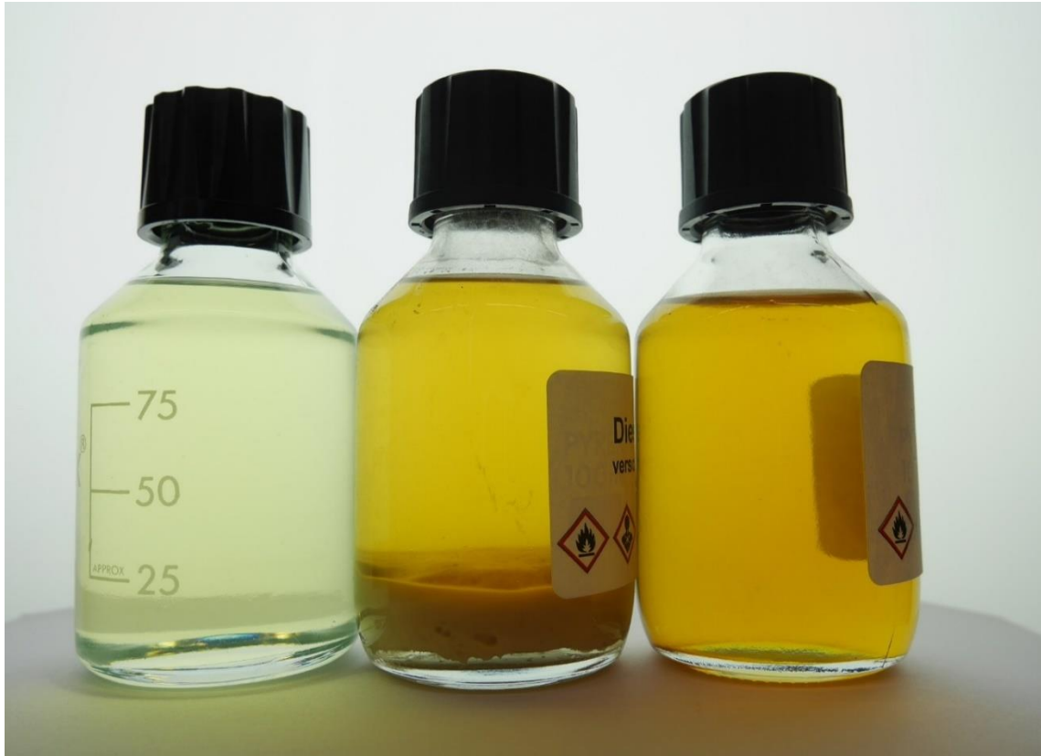
Dieselöl frisch (links), ca. 6 Jahre gealtert mit Mikroorganismen am Boden (Mitte) und ca. 6 Jahre gealtert und trübe ohne Mikroorganismen (rechts)
