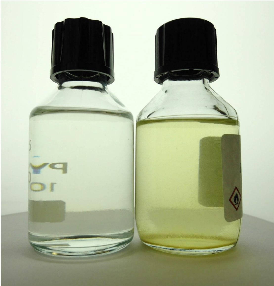
Benzin frisch (links) und ca. 6 Jahre gealtert mit Alterungsprodukten (rechts)
