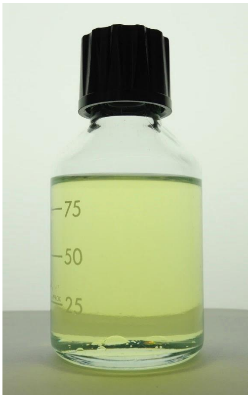
Dieselöl mit freiem Wasser (mehrere Wassertropfen auf dem Boden der Flasche)
