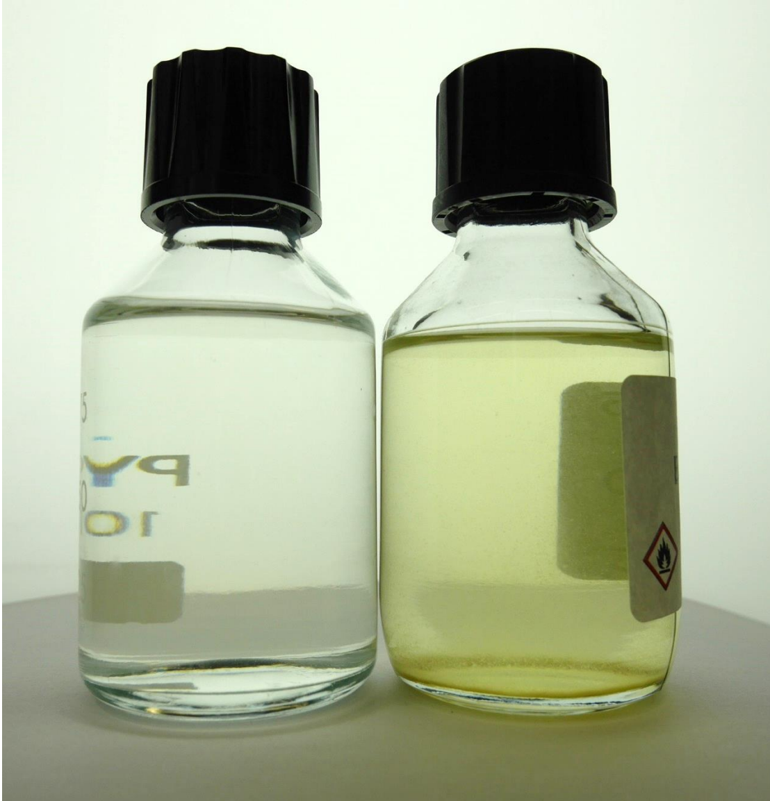
Essence fraîche (à gauche) et essence vieillie d'environ 6 ans avec des produits de vieillissement (à droite)
