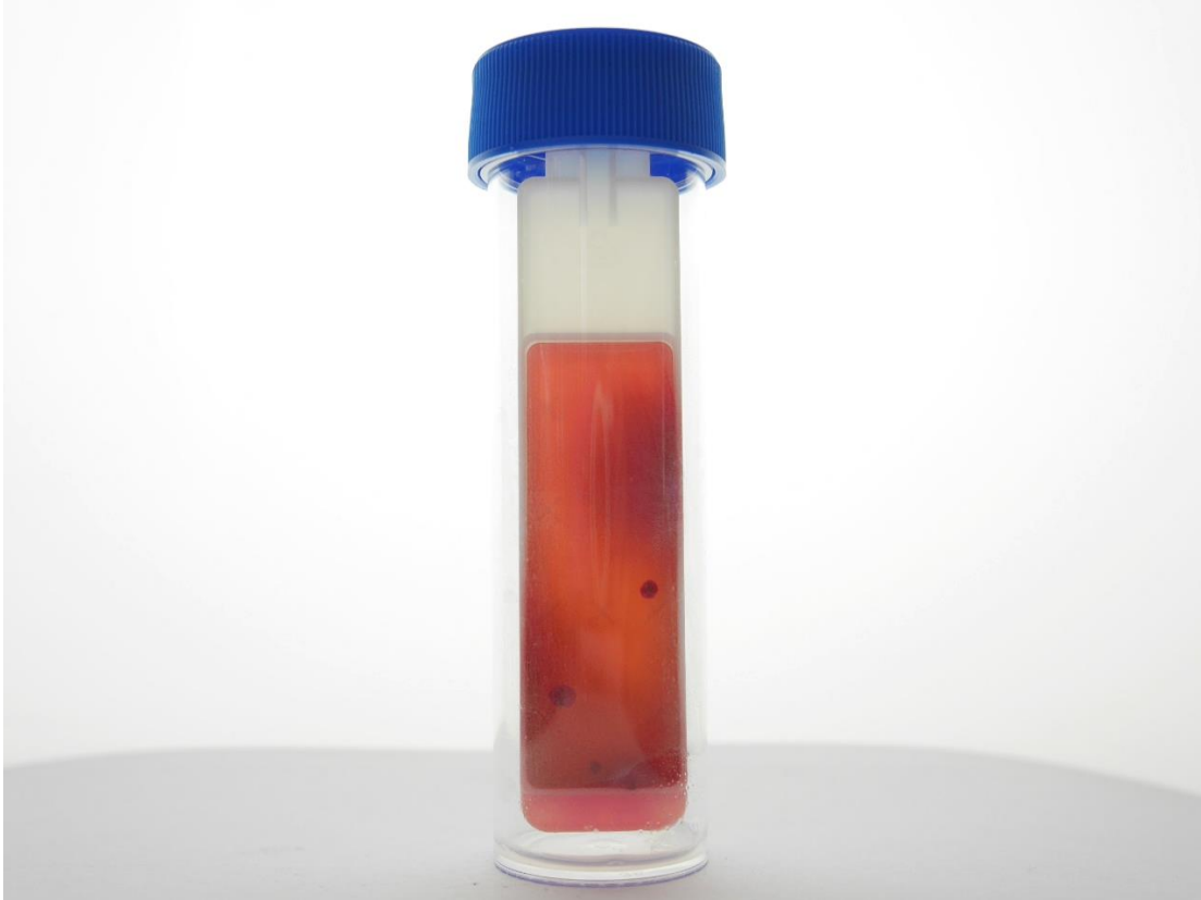
Kit de test avec colonies de bactéries (points rouges)
