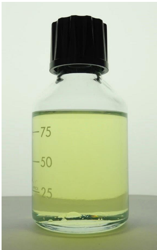
Diesel avec eau libre (plusieurs gouttes d'eau au fond de la bouteille).
