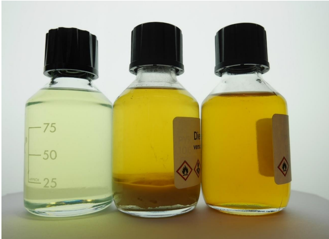
Diesel frais (à gauche), vieilli d'environ 6 ans avec des micro-organismes au fond (au milieu) et vieilli d'environ 6 ans et trouble sans micro-organismes (à droite)
