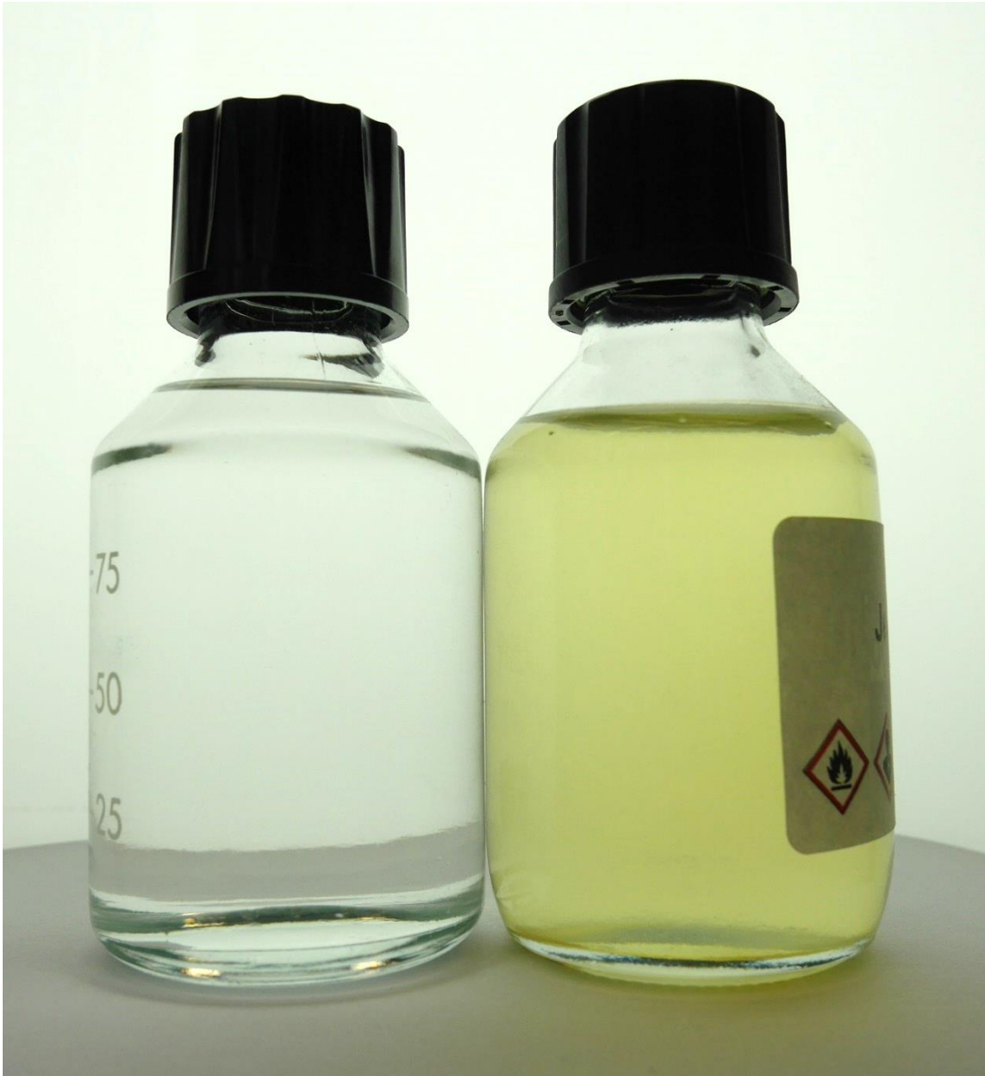
Kérosène/Jet A-1 frais (à gauche) et vieilli d'environ 6 ans et trouble (à droite) (Le bord gris de la table n'est plus visible à travers l'échantillon de droite.)
